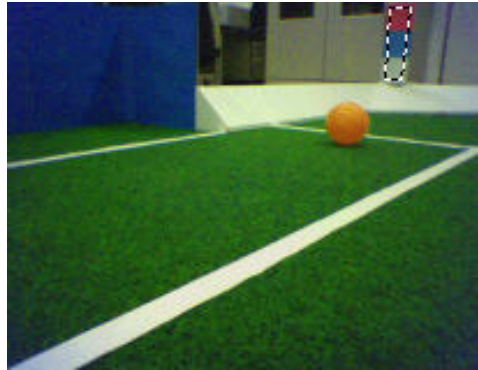
Abbildung 13: Orientierungsturm (Aufnahme Aibo ERS-210A).
